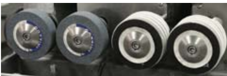
Pedras para desbaste
